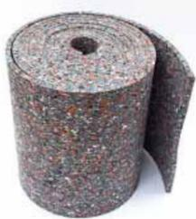
Die Antirutschmatten auf Kautschukbasis wurde speziell für Betonfertigteile konzipiert. Die bunte Granulatmischung verhindert ein Abfärben an Sichtbetonflächen und ist deshalb sehr gut für die Ladungssicherung von Betonfertigteilen geeignet.
